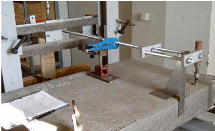
Figur 2. Forsøgsopstilling med liggende betonelement. Konsolbeslaget ses til højre.
