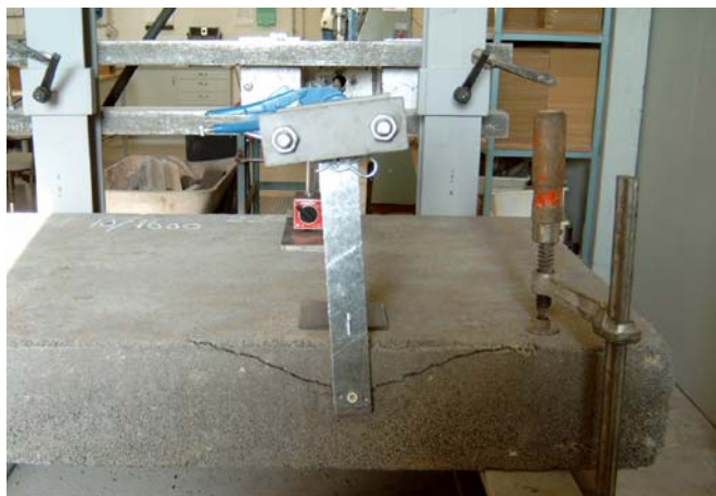
Figur 5. Svigt i letbetonelement i form af afskalning
