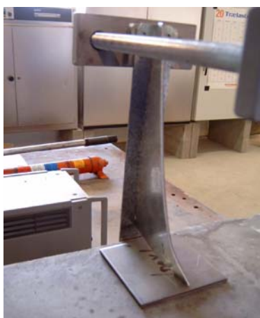
Figur 4. Typisk svigt af konsolbeslagets trekantplade.
