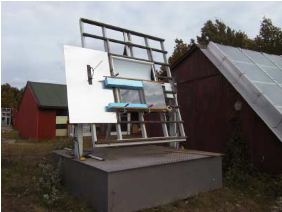
Figur 20: Billede af elementer med forskellig tykkelse HoneyComb opsat i DTU's udendørs soltracker. Planet med målepind til registrering af indfaldsvinkel ses til venstre.
