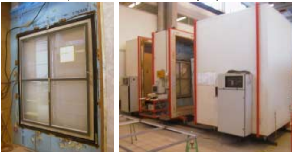
Figur 2: Montering af HoneyCombten i hot boxen. Billedet til venstre viser HoneyCombten monteret i isoleringsvæggen set fra den varme side og billedet til højre viser hele forsøgsopstillingen før opstart. De tre kasser spændes helt sammen når forsøget startes.
