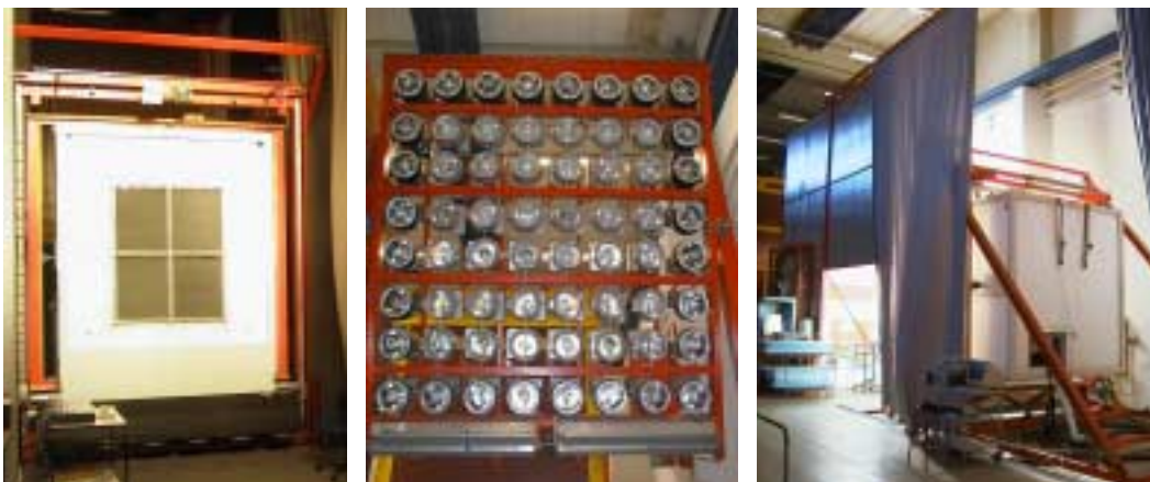
Figur 8: Til højre ses HoneyComben monteret i målekasse. I midten ses solsimulatoren, og til venstre ses hele forsøgsopstillingen.
