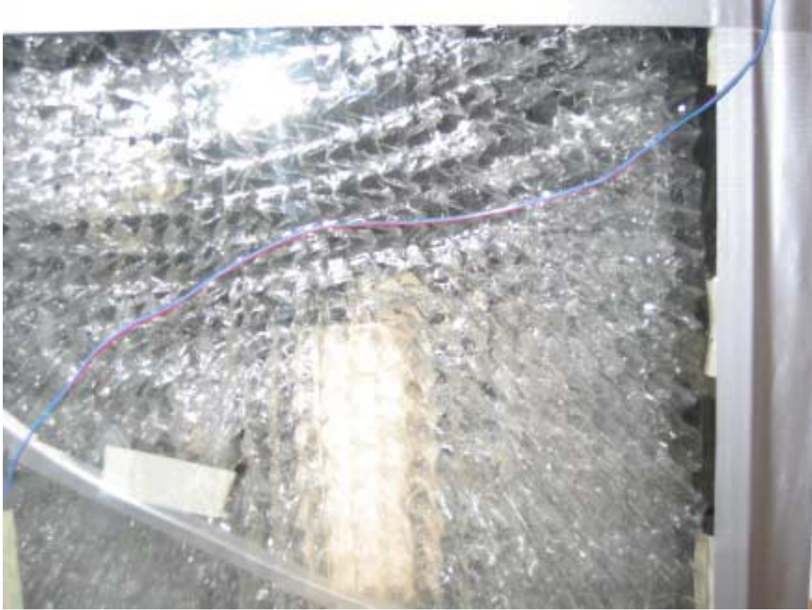
Figur 24: Billede af dæklagsselementet efter stagnationsprøvning. Det ses at polykarbonatfolien hænger i bølger på bagsiden. Desuden ses der aflejring af materiale på glasset svarende til hvis der havde været forekomst af dug indvendigt. Kanterne af celluloseacetat i HoneyComb materialet blev hvidligt som tegn på begyndende smeltning.
