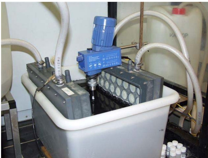
Figur 4: Rensning af ”askepot” aske i 25 l ”badekar” forsøg på DTU.
