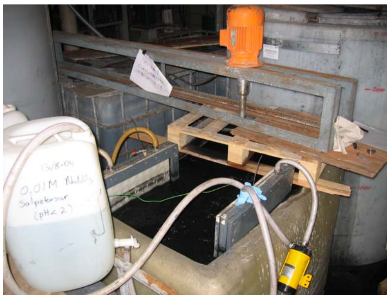
Figur 5: Rensning af ”askepot” aske i 800 l ”palletank” forsøg på Avedøreværket.
