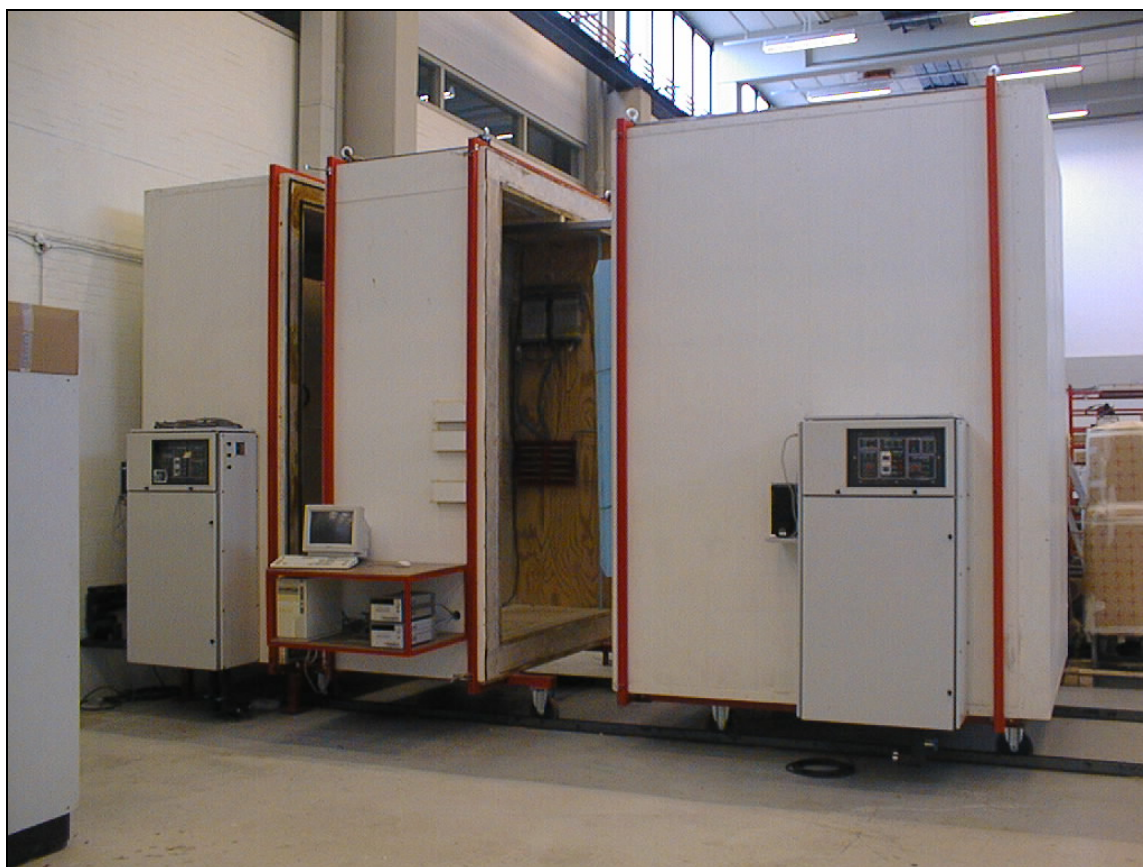
Figur 48 Hot box forsøgsopstillingen i åben tilstand
