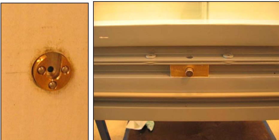
Figur 45 Nærbilleder af akselleje (til venstre) og omdrejningsakslens placering i rammen (til højre)
