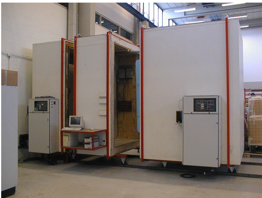
Figur 1 Billede af Hot box'en i BYG·DTU's forsøgshal.
