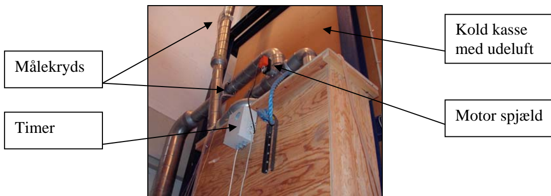
Figur 3.6 Nærbillede af timeren og rørforbindelserne øverst på varmeveksleren
