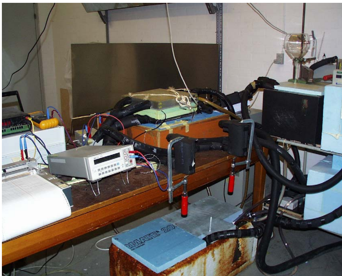
Figur 11 Opstillingen til måling af varmeledningsevne under fugtige forhold.
