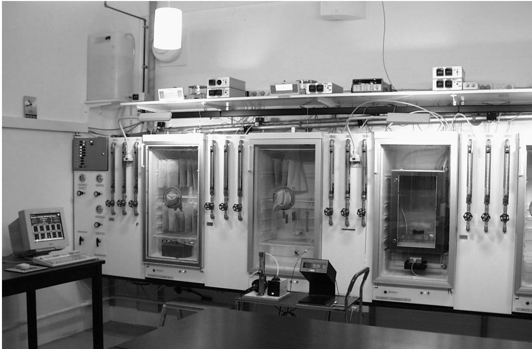
Figur 5 Klimaskabsopstilling på BYG•DTU til bestemmelse af sorptionskurver. Det er klimaskab nr. 2, der er benyttet til forsøg ved 20°C. I forgrunden ses dugpunktmåleren, der benyttes til kontrol af klimaet.
