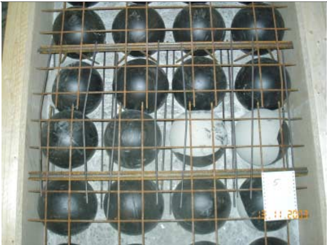
Forsøg vedr. momentkapaciteten af en samling i BubbleDeck
