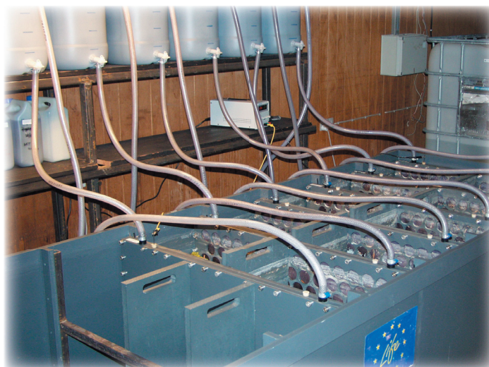
Pilotanlæg til elektrodialytisk rensning. Asken opslæmmes i vand, og cadmium fjernes på ion-form vha. elektrisk strøm
