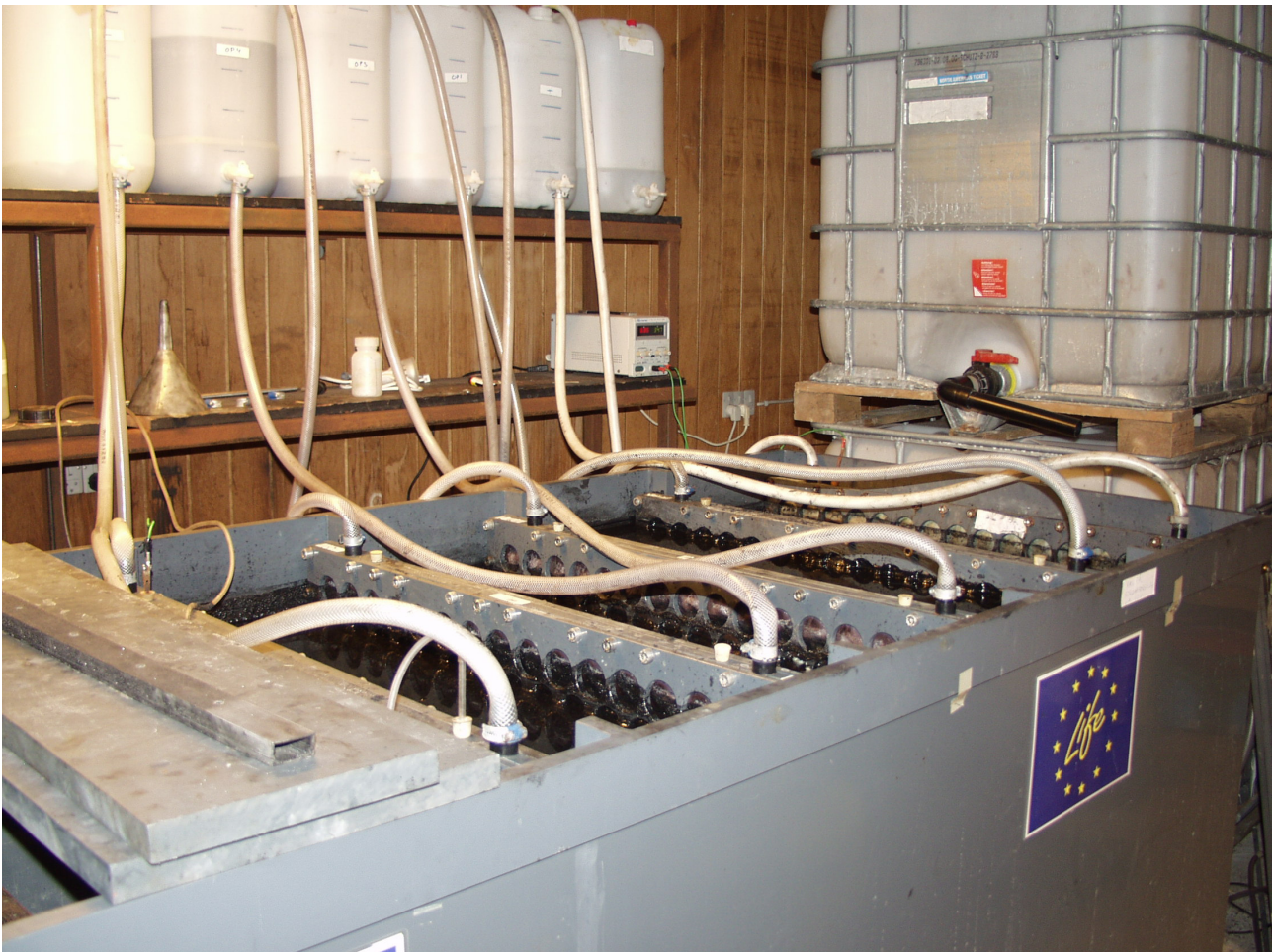
Figur 3: Rensningsforsøg med halmaske i pilotanlægget. Elektrodeafstanden er ca. 140 cm, og der er indsat 3 opsamlingskamre.
