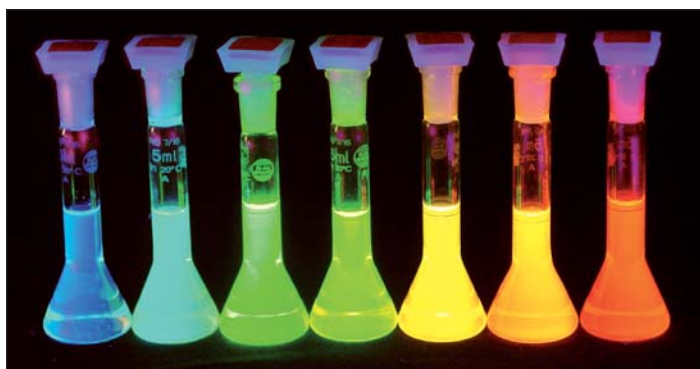
Figur 1. Fluorescens i opløsninger af CdSe-partikler. Partiklernes størrelse varierer fra 2 nm (blå) til 7 nm (orange). (Gengivet med tilladelse fra Dr. Dmitri Talapin og Dr. Andrey Rogach, Hamburg Universitet)
