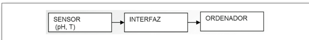
Figura 1. Esquema de un equipo de captación automática de datos.
