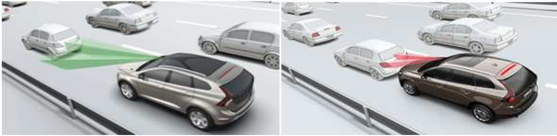
Figura 1.5: Vista general sobre el funcionament del sistema d'aturada dels vehicles de Volvo.
