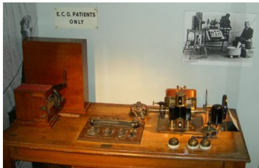
Imatge 3: Galvanòmetre de corda de Willem Einthoven
