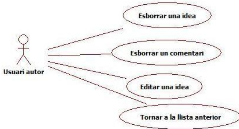
Figura 4.6: Diagrama UML de la fitxa d'edició d'idea
