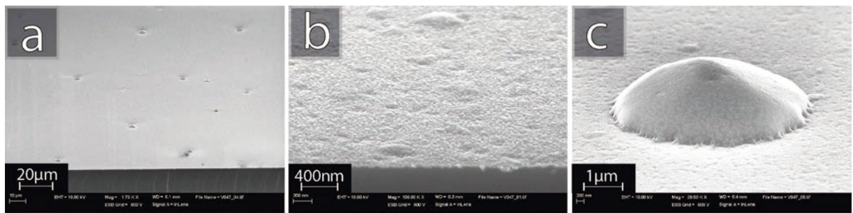
Figura 5. 19 Imágenes en detalle de los montículos formados de material eutéctico.
