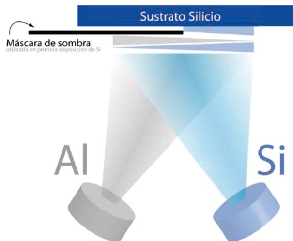
Figura 5. 20 Esquema del proceso de la formación de capas gradiente y como se emplea la máscara en la primera evaporación para conseguir sustratos bicapa y tricapa.
