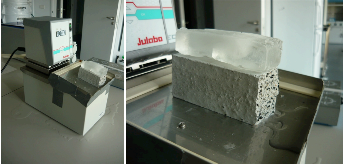
Fig. 7. Sistema experimental para la determinación del coeficiente de conductividad térmica.
