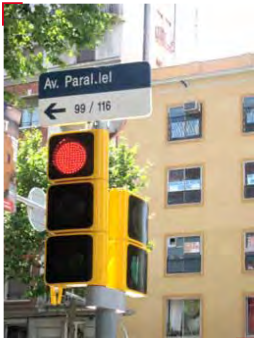
Fig.7: El semáforo con lámparas de "leds" es mucho más visible (y por tanto más seguro) que el tradicional, especialmente a contraluz o cuando inciden directamente sobre él los rayos solares.
