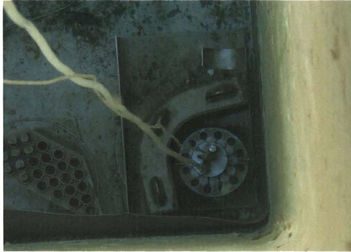
Figura 3.18: Fotografía de la unidad de irradiación NAYADE, donde se puede ver el contenedor de las muestras y las fuentes de  $^{60}\text{Co}$  en configuración cilíndrica
