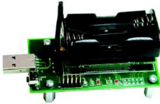
Figura 9. IRIS muntada sobre MIB520CB
