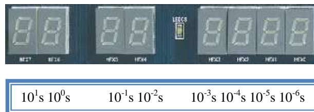
Figura 7 Assignació de la precisió del cronòmetre en els 8 displays
