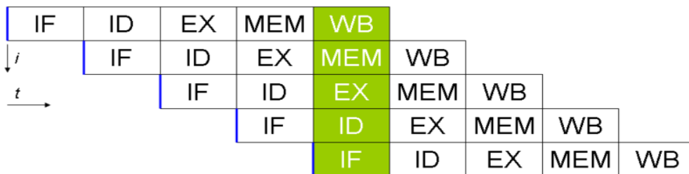
Fig. 2.2: Ejemplo ejecución en procesador pipelined
