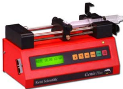
Figura 19. Bomba utilitzada en el CVD. Omplerta amb aigua i etanol utilitzada en la síntesi de nanofibres de carboni per mitjà de la tècnica CVD.
