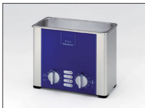
Figura 47. Bany d'ultrasons FB15060 de la casa Fisher Scientific. Aquí es sonifiquen la barreja de nanofibres de carboni, el dissolvent i els pelets d'ABS durant 1 hora a temperatura ambient.
