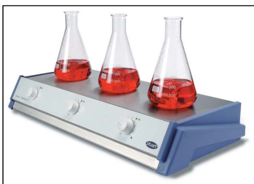
Figura 46. Agitador magnètic analògic SB-161/3 de la casa Stuart. Aquí s'agita la barreja de nanofibres de carboni, el dissolvent i els pelets d'ABS, per tal de desfer aquests últims i uniformar la barreja.
