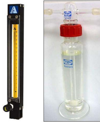
Figura 20. Cabalímetre i saturador utilitzats en el CVD. A l'esquerra, cabalímetre utilitzat en la síntesi de nanofibres de carboni per mitjà de la tècnica CVD. A la dreta, el saturador emprat en la transformació del precursor d'estat líquid a estat gasós.
