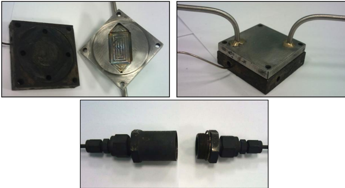
Figura 17. Imatge de los dos tipus de microreactors. A dalt, dos imatges del microreactor per contenir suports en forma de plaques, obert i tancat. A sota, imatge del microreactor per a suports catalítics cilíndrics.
