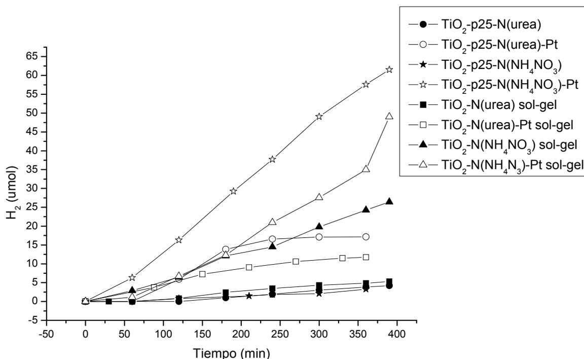
**Figura 5.** Generación de H<sub>2</sub> en función del tiempo de reacción, para los fotocatalizadores TiO<sub>2</sub>-N y TiO<sub>2</sub>-N-Pt bajo irradiación con luz visible. 1 gramo de muestra fue puesta en 500 mL de una solución acuosa de ácido fórmico 10<sup>-3</sup>M a pH= 3,62.
