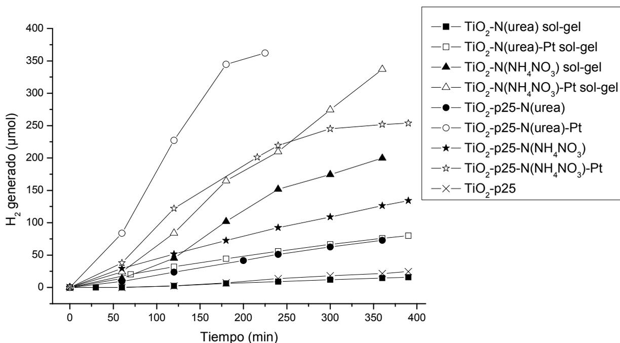
**Figura 6.** Generación de  $H_2$  en función del tiempo de reacción, para los fotocatalizadores  $TiO_2-p25$ ,  $TiO_2-N$  y  $TiO_2-N-Pt$ , bajo irradiación con luz ultravioleta. 1 gramo de muestra fue puesta en 500 mL de una solución acuosa de ácido fórmico  $10^{-3}M$  a  $pH= 3,62$ .
