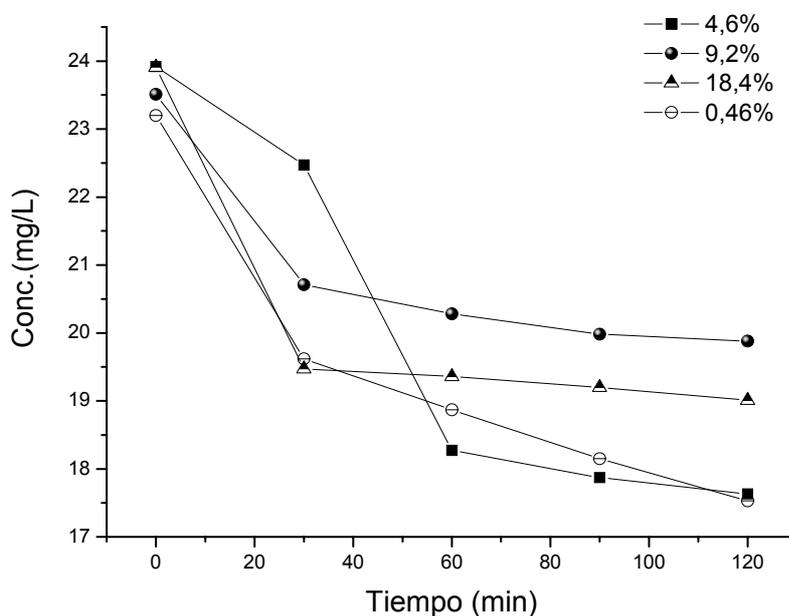
**Figura 1.** Evolución de la concentración de ácido oxálico en función del tiempo, bajo irradiación con luz visible, cuando se uso el  $\text{TiO}_2\text{-N}$  preparado por el método sol-gel. Contenido teórico de N para cada muestra fue de 0.46, 4.6, 9.2 y 18.4%.  $[\text{H}_2\text{C}_2\text{O}_4]=24 \text{ mg L}^{-1}(10^{-3} \text{ M})$ ;  $\text{pH}=3$ .
