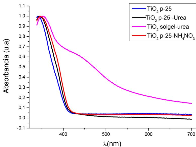
**Figura 3.** Espectros de absorbanza correspondientes a los fotocatalizadores de TiO<sub>2</sub> dopados y al TiO<sub>2</sub>-p25.
