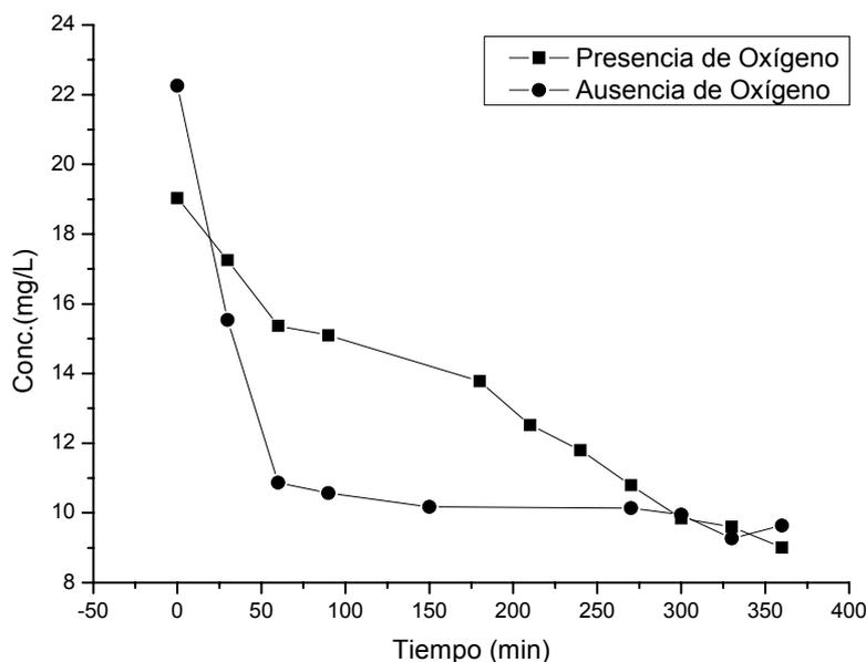
**Figura 7.** Mineralización de una solución de ácido fórmico ( $10^{-3}\text{M}$ ) en presencia de oxígeno y en ausencia de este, mientras se producía hidrógeno utilizando  $\text{TiO}_2\text{-p25-N}(\text{NH}_4\text{NO}_3)\text{-Pt}$  irradiado con luz visible.
