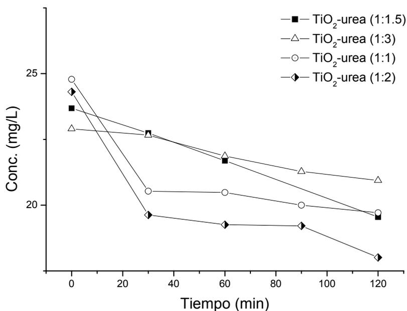
**Figura 2.** Cinética de degradación de ácido oxálico (ppm) para las muestras de  $\text{TiO}_2$ -p25-N(urea) bajo irradiación con luz visible.  $[\text{H}_2\text{C}_2\text{O}_4]=25 \text{ mg L}^{-1}(10^{-3} \text{ M})$  pH=3.
