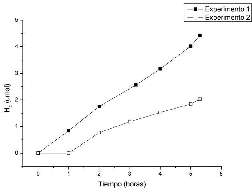
**Figura 8.** Generación de H<sub>2</sub> en función del tiempo de reacción, para el fotocatalizador TiO<sub>2</sub>-p25-N(urea) bajo irradiación con luz visible. 1 gramo de muestra fue utilizada con 500mL de una solución acuosa de ácido oxálico al 10<sup>-3</sup>M a pH= 3,62.
