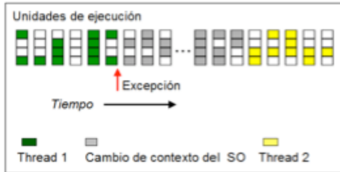
Figura 5: Cambio de Hilo del SO en un entorno multiprogramado.
