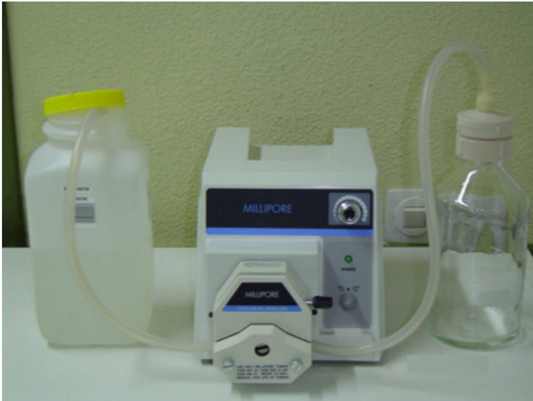
Figura 1. Equip de filtració automàtica d'aigües per la recerca de Legionella.
