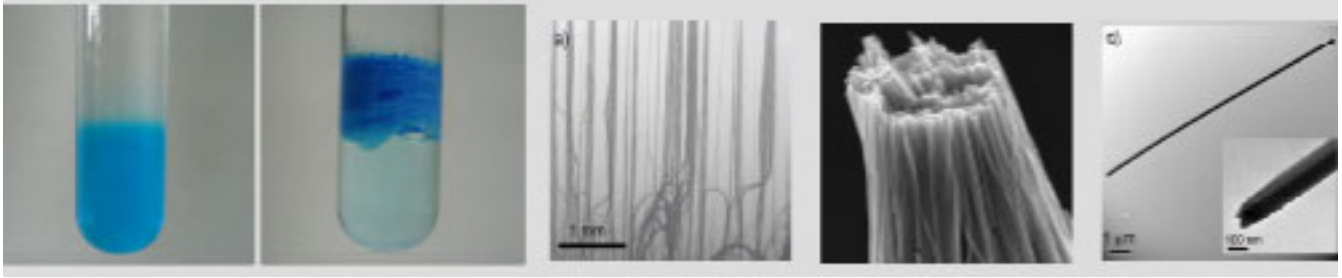
Figura.- Nanomaterials híbrids metalorgànics. A l'esquerra, les fibres nanoscòpiques de metall-aminoàcid es formen utilitzant un mètode de polimerització coordinativa en la interfase orgànica/aquosa. A la dreta, imatges de microscopi òptic (a), FESEM (b) i TEM (c), de nanofibres de Cu-aspartat de gran longitud (5 mm) amb un diàmetre nanoscòpic (100 nm).
