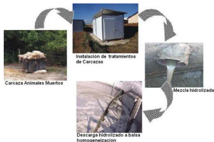
Figura 3. Mètode d'exemple d'hidròlisi tipus Bunker.
