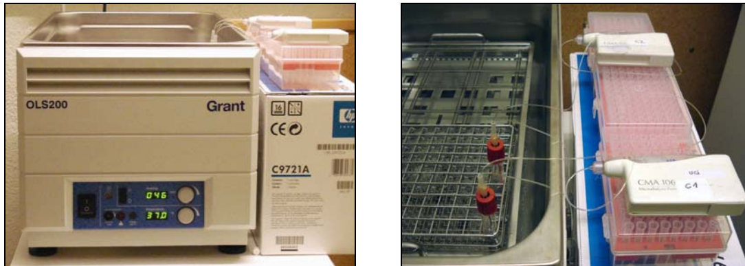
Figura 18. Imágenes del sistema de recuperación in vitro utilizado. En la imagen de la izquierda se muestra una vista general del montaje. En la imagen de la derecha se muestra un detalle de las bombas de perfusión, los catéteres y los tubos con la solución.
