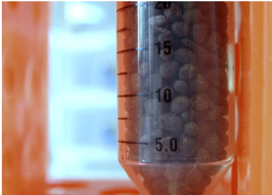
Detall del nou material híbrid, consistent en esferes d'argil·la recobertes de compost.
