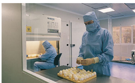
Fotografía 7. Empleado equipado con calzado, mono y equipos de protección. Al fondo, una cabina de seguridad biológica. (Hipra)
