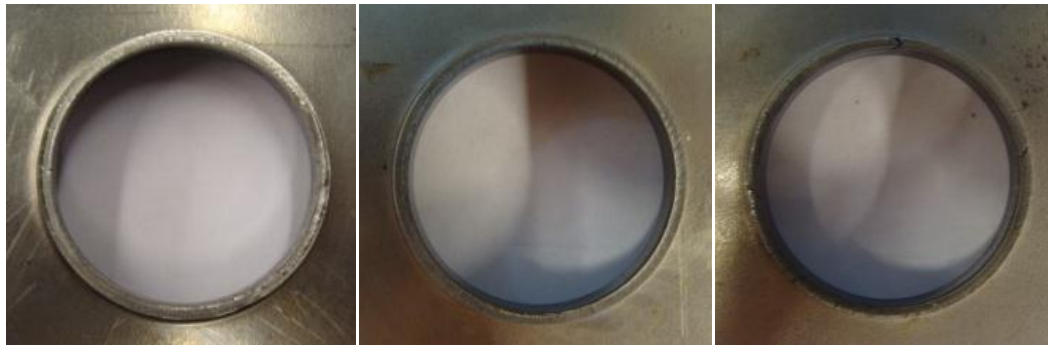
Fig.4.4- DOCOL1200: (a) proveta punxonada a D23 T5%; (b) proveta punxonada a D19 T12%; (c) proveta punxonada a D19 T20%
