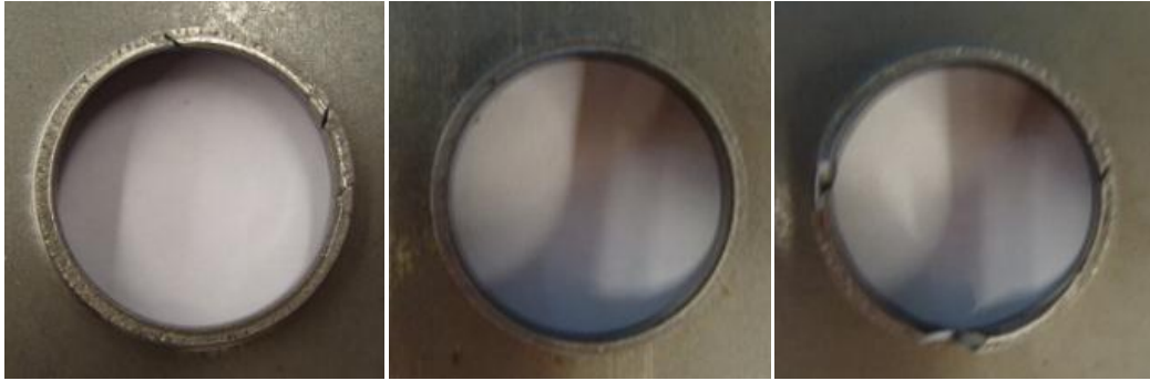
Fig.4.2- MSW1200: (a) proveta punxonada a D23 T5%; (b) proveta punxonada a D19 T12%; (c) proveta punxonada a D17 T20%
