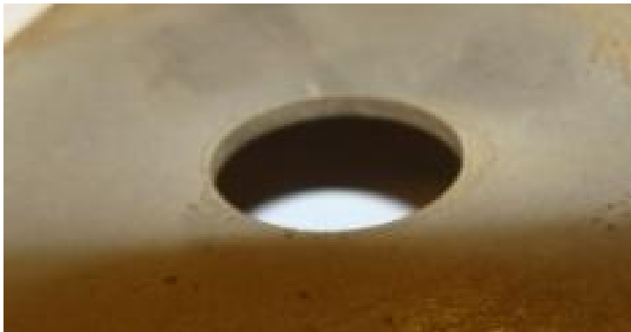
Fig.2.10- Imatge del forat tallat amb tall per aigua
