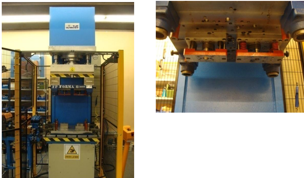
Fig.3.3- (a) Premsa hidraulica; (b) detall matriu d'esbocat / punxonat.
