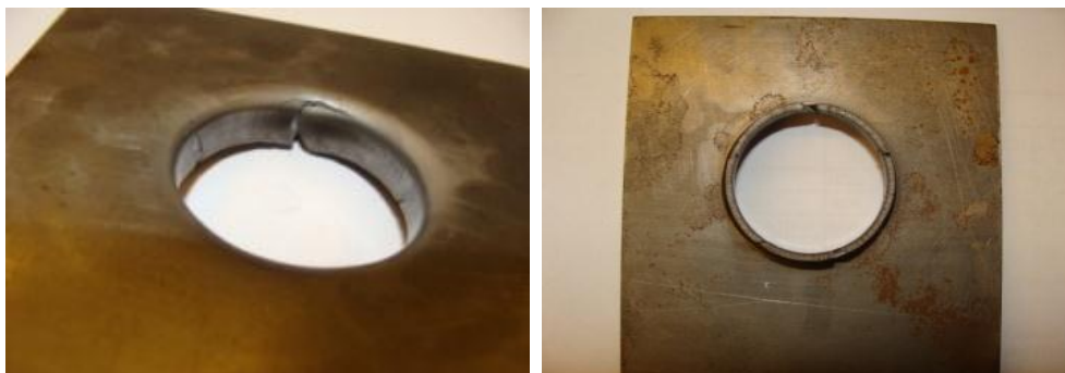
Fig.4.7- DP980: (a) proveta tallada amb aigua D19 i esbocada en el mateix sentit de tall; (b) proveta tallada amb aigua D19 i esbocada en el sentit contrari de tall.
