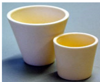
Figura 18. Gresol d'alúmina emprat per a l'anàlisi TG. Font: http://spanish.alibaba.com/search/alumina-crucible-1.html
