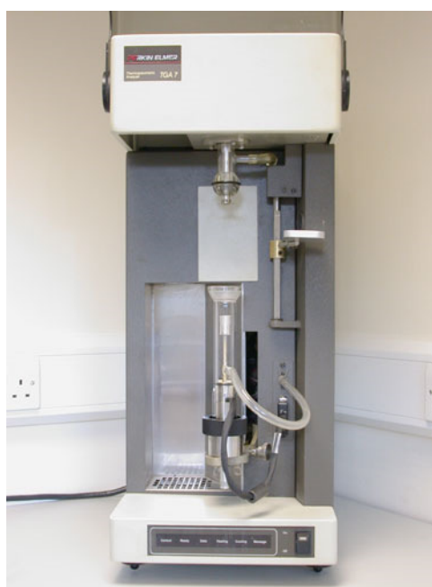
Figura 19. Equip de termogravimetria PerkinElmer TGA7, emprat per a les anàlisis d'aquest projecte. Font: http://www.materials.co.uk/tga.htm
