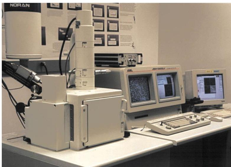
**Figura 3.3** Equipo utilizado de Microscopía Electrónica de Barrido ubicado en la UAB.
