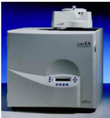
**Figura 3.4** Equipo utilizado para la técnica de caracterización de Análisis Elemental ubicado en el Servicio de Análisis Químico de la UAB.
