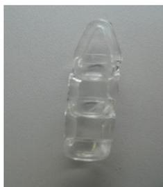
**Figura 3.5** Portamuestras utilizado en el TGA en el Laboratorio de Reactividad de Gases ubicado en Matgas
