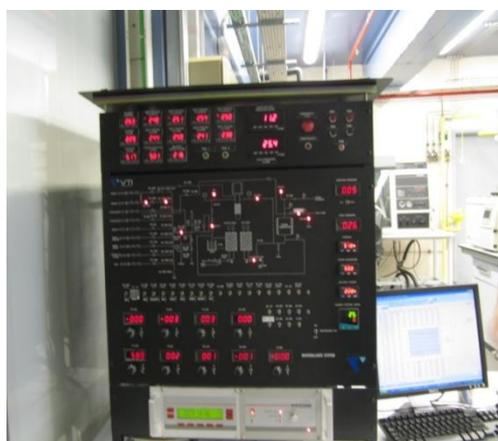
**Figura 3.6** Equipo utilizado SIM para la técnica TGA.
