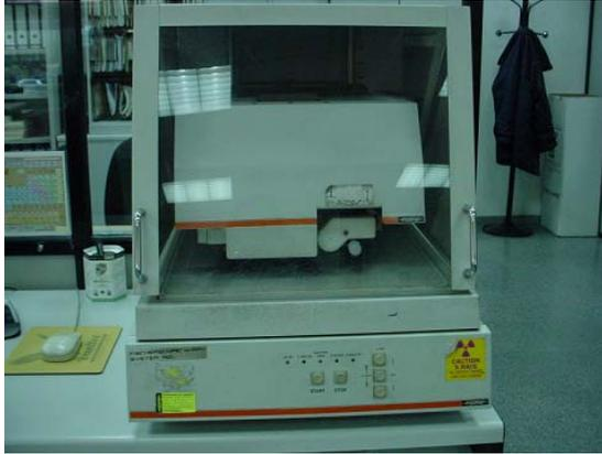
*Equipo de medición de espesores por rayos X*
