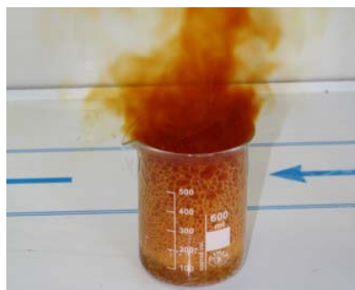
Figura 1. Reacció exotèrmica amb alliberament de compostos de nitrogen.
