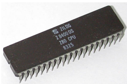
Imagen 1.5 - Microprocesador Zilog Z80
