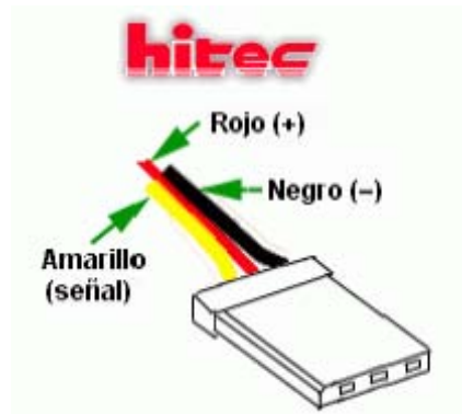
Figura 17 – cableado servo Hitec
