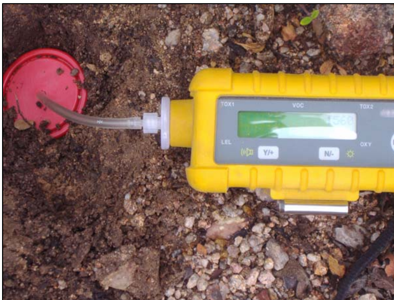
Fig. 16: Mesura de CO 2 al camp amb sonda de gasos RAE
