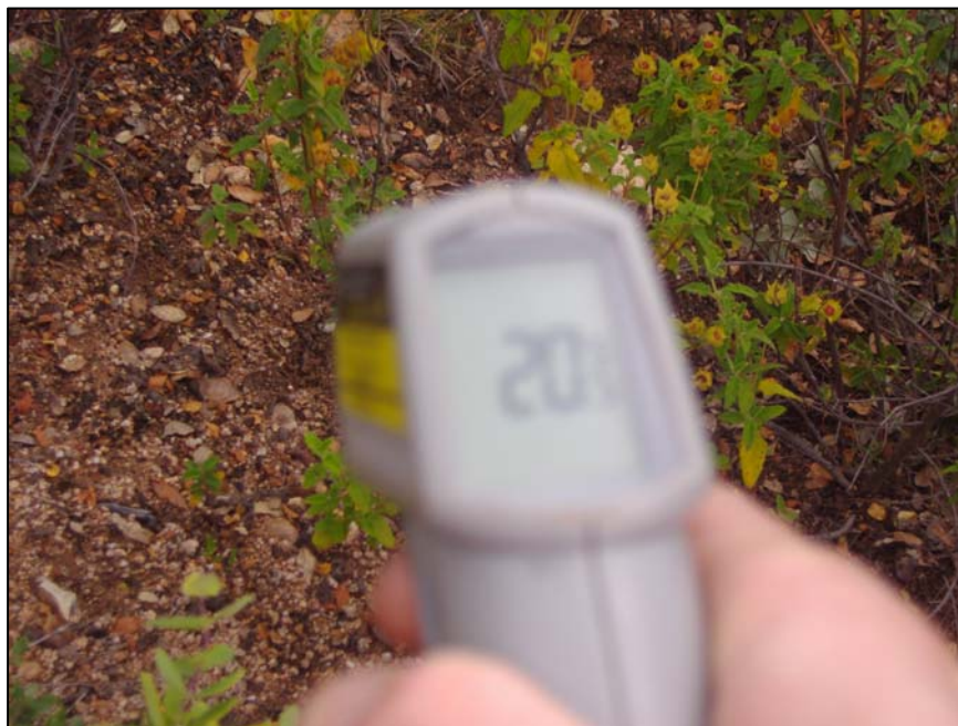
Fig. 15: Mesura de la temperatura del sòl amb termòmetre IR
