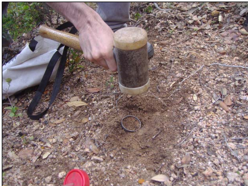
Fig. 14: Mostreig de sòl amb anell cilíndric
