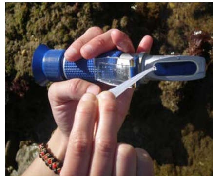
Figura 17: Modo de empleo del salinómetro. (Elaboración propia)
