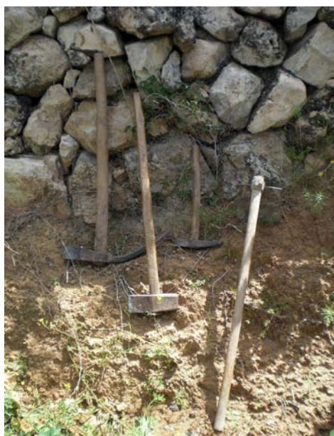
Figura 4.2. Eines necessàries per fer un marge: d'esquerra a dreta, respectivament, l'aixada estreta, el mall, la picola i l'aixada ampla; al costat, l'aixada i el cabàs de pauma. Font: pròpia.
