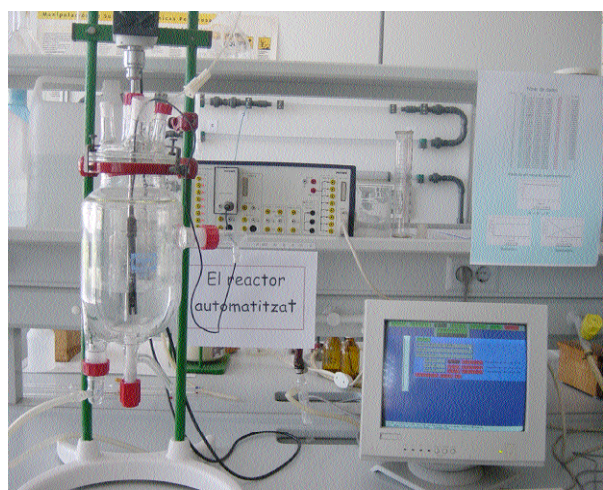
FIG. 6 Planta piloto del reactor.
