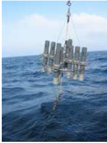
Fig. 7 Recollida d'una de les trapes. Font: Elaboració pròpia
