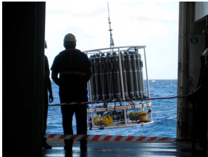
Fig. 3 Roseta oceanogràfica amb la sonda CTD, ampolles Niskin i part de l'equip tècnic encarregat de llençar-lo. Font: elaboració pròpia.
