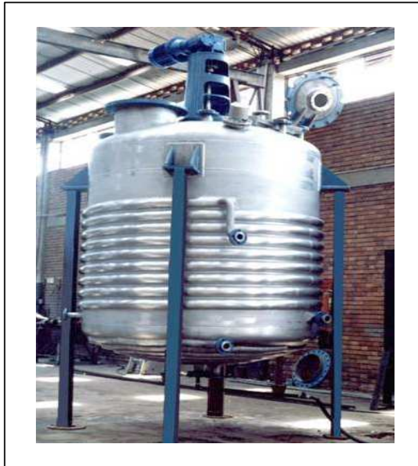
Figura 11.8. Instal·lació d'un bescanviador de mitja canya al voltant d'un reactor
