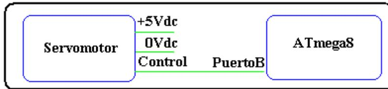
Figura 10. Conexión del servomotor
