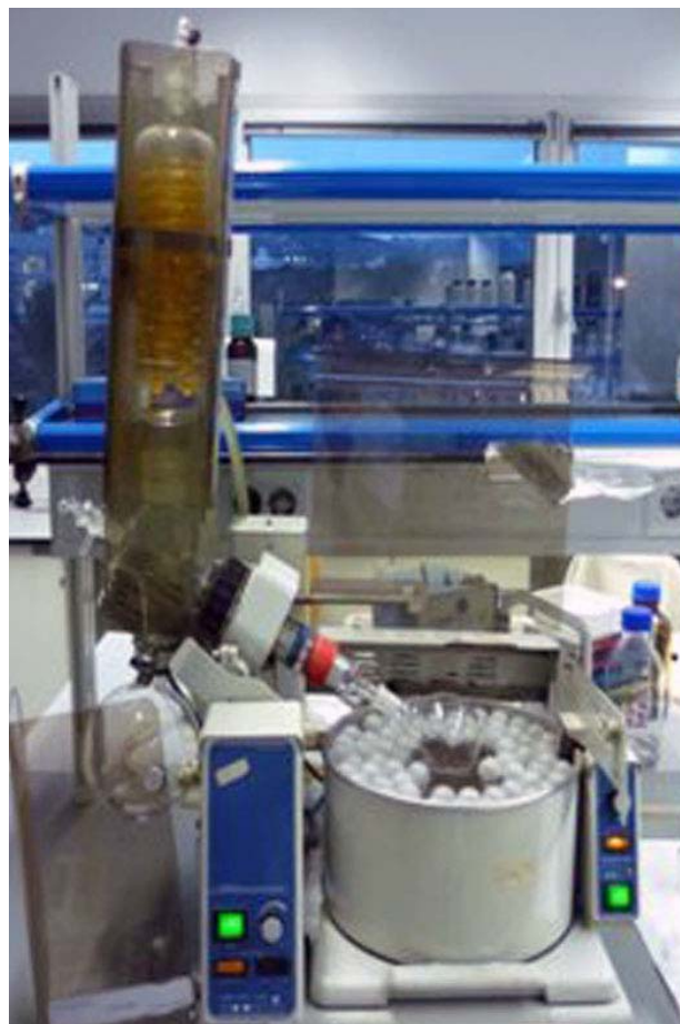
Figura 5. Rotavapor que ens permetrà separar la cafeïna del clorur de metilè.
