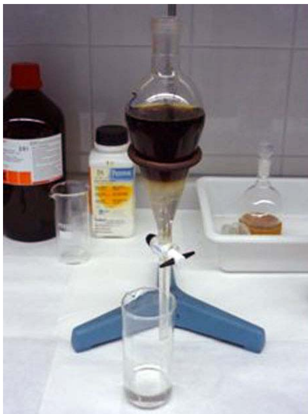
Figura 4. Embut de decantació en el que es realitza l'extracció de la cafeïna de la Coca-Cola amb clorur de metilè.
