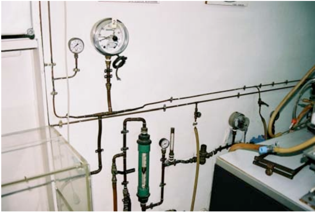
Figura 48: Part del circuit d'hidrogen i heli del laboratori de RX (fotografia de l'autor).
