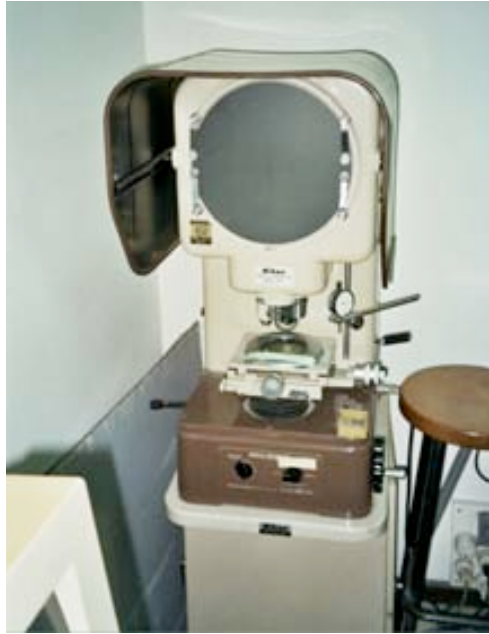
Figura 34 : fotografia del projector de perfils Nikon Model 6C, nº 11318, adquirit l'any 1969 (fotografia de l'autor).
