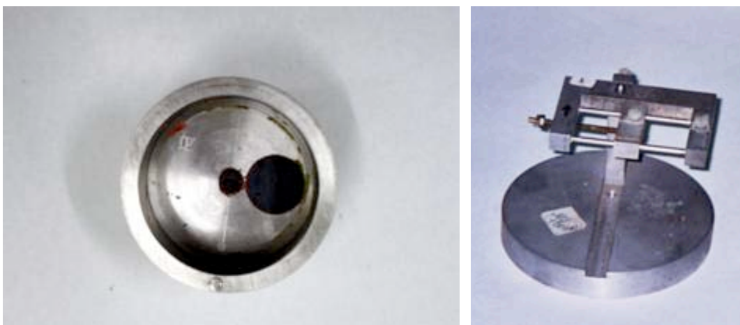
Figura 46: Part B de la càmera RICH IV, amb l'imant afegit per fixar l'estirador de fibres (fotografia de Joaquim Lloveras). A la dreta, l'estirador de fibres (fotografia de l'autor)
