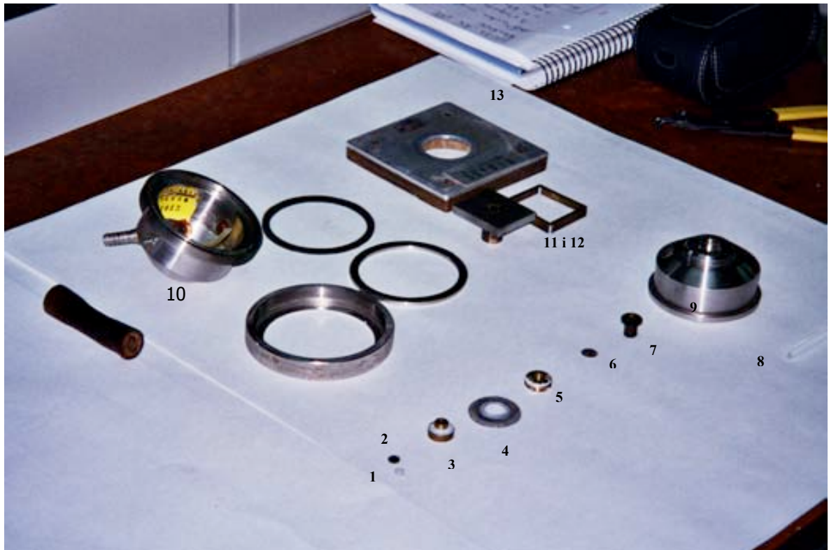
Figura 44 : Desmuntatge de la càmera RICH IV. (fotografia de l'autor)
