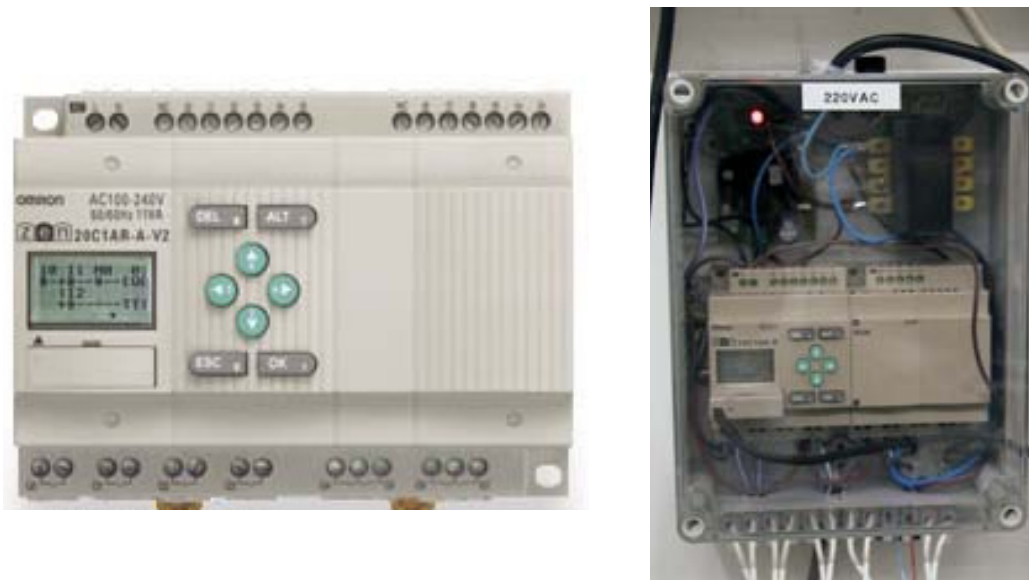
Figura 5.4. Mòdul lògic programable ZEN-10-C1DR-D i la seva expansió ZEN-8EDR i el quadre elèctric que alimenta el sistema
