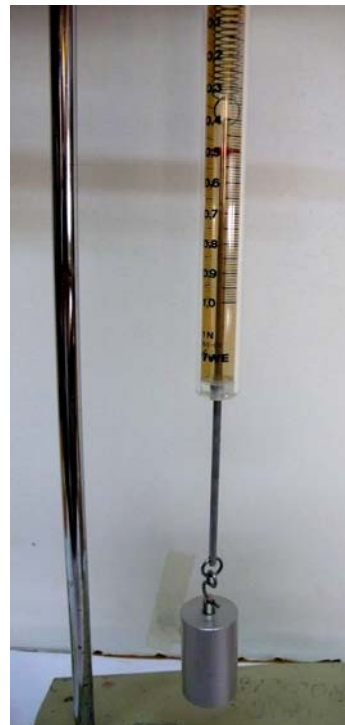
Figura 14. Lectura del dinamòmetre: 0,49 N, corresponent al pes real del cilindre (suspès a l'aire).
