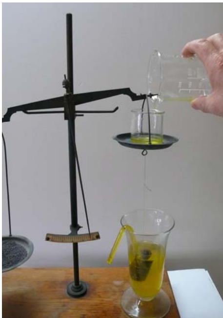
Figura 10. Balança en procés de recuperació del seu equilibri, contrarestant l'empenyiment amb el pes de l'aigua desallotjada.
