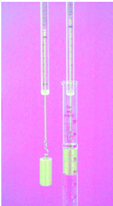
Figura 13. A la foto s'observa la diferència entre el pes real (a l'aire) del cilindre i el seu pes aparent (diferència entre el pes real i l'empenyiment).
