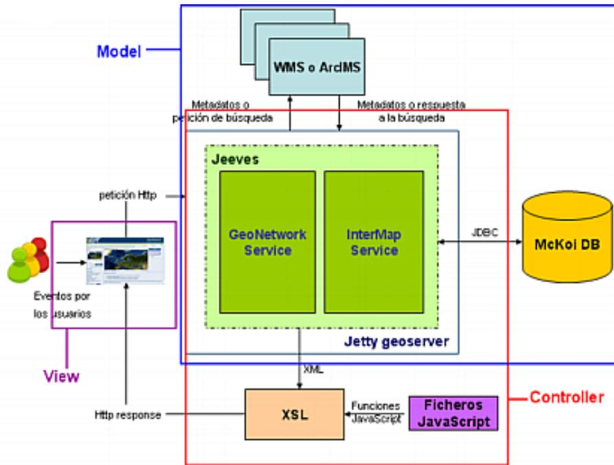
Fig. 3.9 - Vista de la arquitectura del Geonetwork evidenciada por el modelo MVC.
