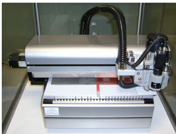
Figura 7.2 Fotografia de la fresadora LPKF ProtoMat H100 utilitzada per a la fabricació de prototipus.
