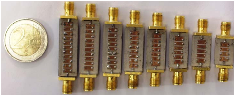
Figura 7.2 Fotografia dels dispositius fabricats; D'esquerra a dreta el nombre d'etapes de cada línia és menor, començant per 11 etapes i acabant amb 4 etapes.
