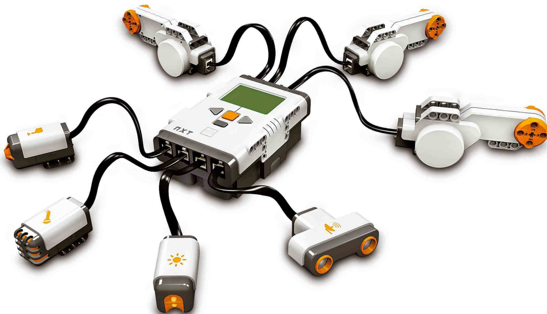
Figura 2-9. Legó Mindstorms NXT amb sensors i actuadors connectats
