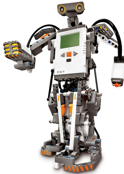
Figura 2-13. Robot controlat amb el bloc NXT
